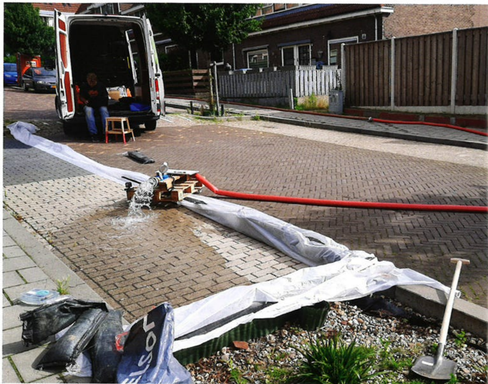
Full scale-test aan doorlatende verharding in de Reestraat 2020 (vooraan regenwatertuin en op foto diverse soorten doorlatende verharding).
